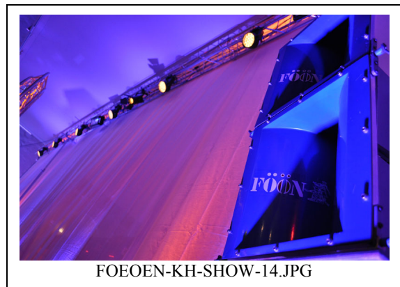
Foto 9: Mittelhochton Line-Array Element GLA mit einer „ungewöhnlichen“ 2+1 Bestückung.
