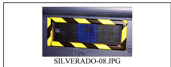
Foto 5: Nicht zu übersehendes Front-Fill System com Typ V1101 im Baustellen Design.
